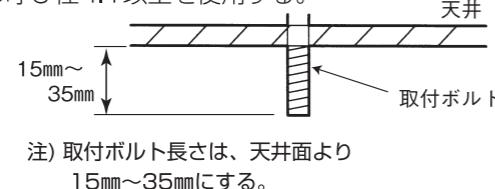
注) 取付ボルト長さは、天井面より 15mm~35mm にする。
